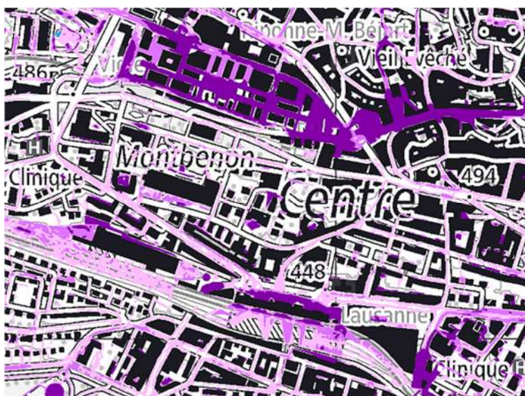
Gefährdungskarte Oberflächenabfluss im besonders stark betroffenen Bereich Flon / Rue Centrale sowie Bahnhof Lausanne. (Karte: BAFU / Swisstopo)
